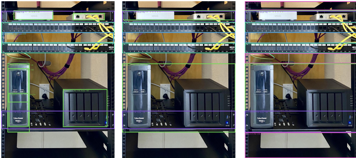
(a) Objekterkennungsergebnisse ohne festgelegten Konfidenz -Schwellenwert. (b) Optimierte Objektvorhersagen durch Algorithmus A.1 mit den beschriebenen Schwellenwerten. (c) Vollständige Steckplatzanalyse durch Algorithmus A.2 mit den beschriebenen Schwellenwerten.
